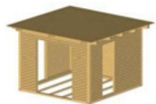
Coffrage de toit et de mur
